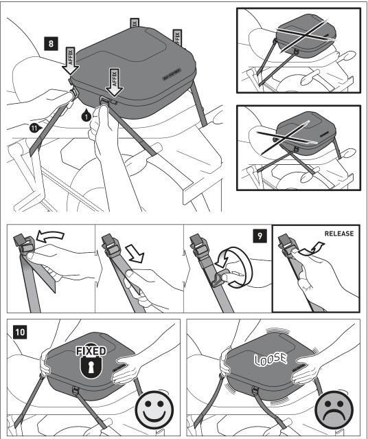
Schritt [8]: Befestigen Sie nun die Hakenschnallen der VIER Schlaufgurte (11) beidseitig an den in der Zeichnung gezeigten Schlaufen des Topcase (1).
